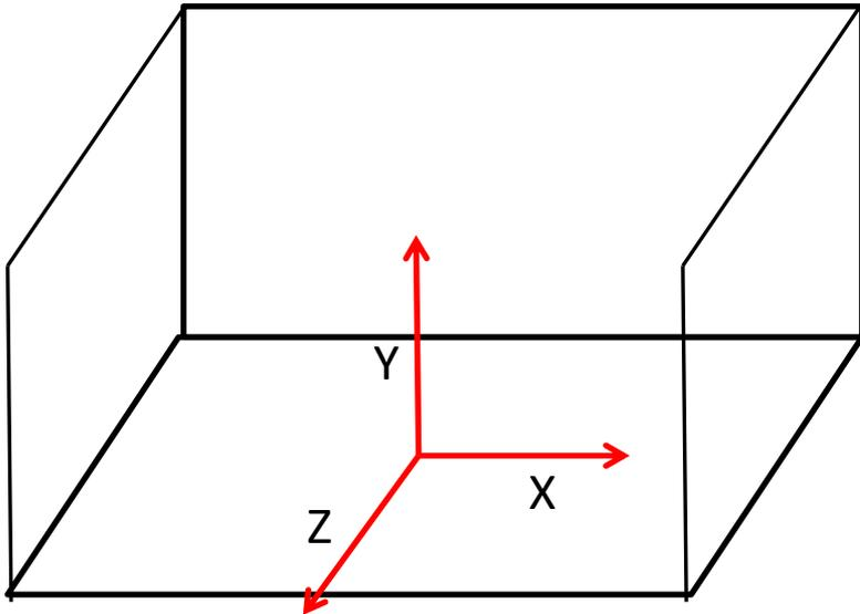
県立大のCAVEシステムのVR空間の大きさは、 $2\text{m} \times 2\text{m} \times 3.2\text{m}$ である。
